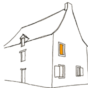
Création d'une ouverture (bâti médiéval)
